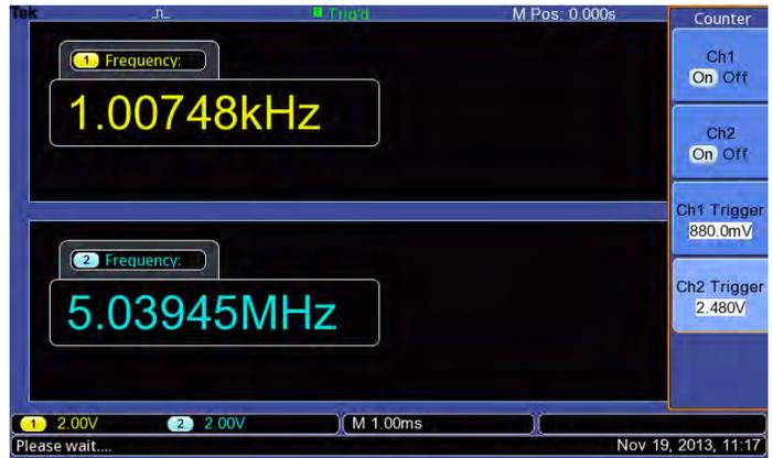
Un contador de frecuencia de dos canales de 6 dígitos, viene de forma estándar en todos los modelos TBS1000B-EDU.
