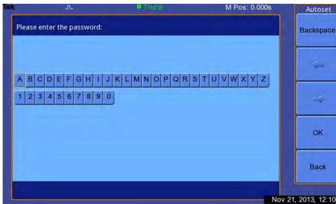
La función de "Autoajuste" se puede activar o desactivar al introducir un password en el menú de Utilidades.
